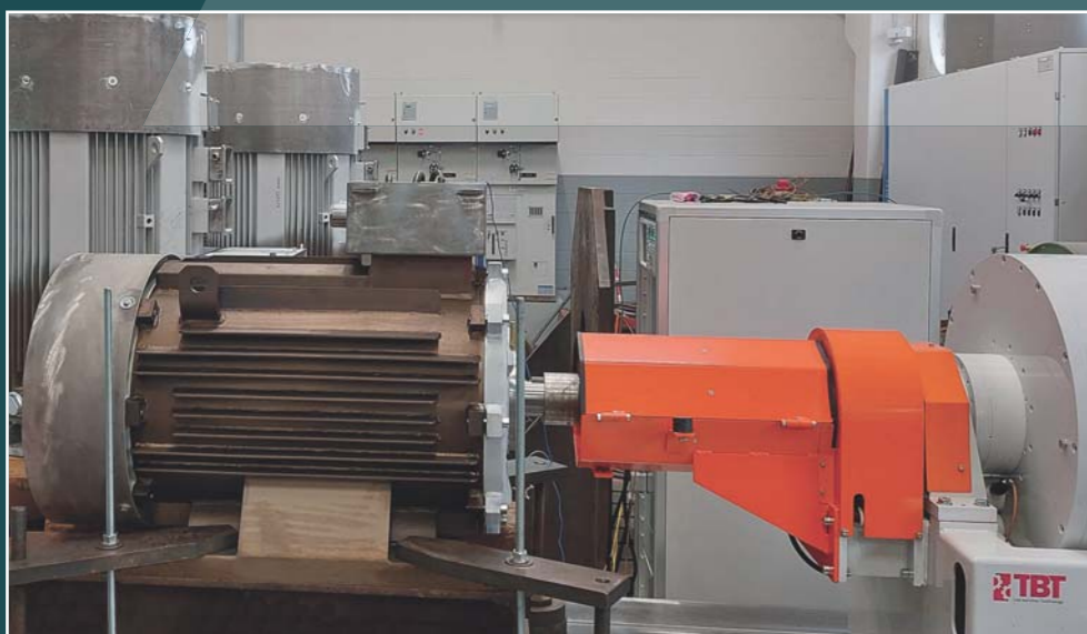
Banco prova industria 4.0: test a carico di motore marino
